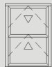
Móvel + Móvel com 2 basculantes Double sash window with 2 hopper windows Mobile + Mobile avec 2 vantaux à soufflet
