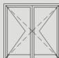
Porta | Door | Porte Batente int|ext 1|2 folhas french door in|out 1 |2 leaves à la française int|ext 1|2 vantaux
