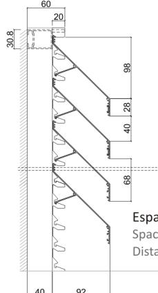
Espaçamento entre lâminas - 68mm
