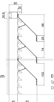
Espaçamento entre lâminas - 102 mm
